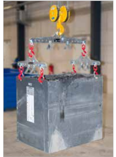
Kombination aus mehreren Traversen zur H-Traverse
